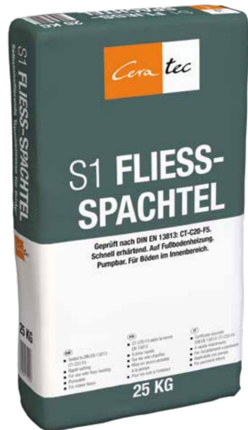
Selbstnivellierende, schnellerhärtende Ausgleichsmasse zur Egalisierung unebener Böden im Innenbereich bis 30 mm Schichtdicke. Ceratec S1 Fließ-Spachtel ist ein selbstverlaufender, schnellerhärtender Bodenspachtel auf Zementbasis für trockene Innenbereiche zum Ausgleich von Unebenheiten mit einer Schichtdicke von 2 – 30 mm.
