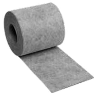
Flexible, beidseitig mit Vlies beschichtete Systemkomponente der Ceratec DF1 DEB Dicht- und Entkoppelungsbahn innerhalb von Verbundabdichtungen gemäß DIN 18534. Rissüberbrückend, alkali- und alterungsbeständig aus reißfestem Polyethylen.
