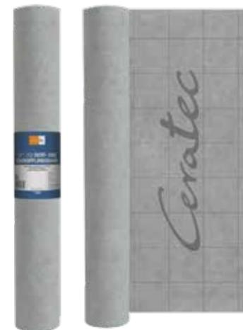
Wasserundurchlässige, rissüberbrückende, beidseitig vliesbeschichtete Polyethylen-Abdichtungsbahn. Zum sicheren und flexiblen Abdichten und Entkoppeln in Innenbereichen, Duschen und Badezimmern vor Fliesenarbeiten gemäß DIN 18534 Teil 5 in den Wassereinflussklassen W0-I „Gering“, W1-I „Mäßig“ und W2-I „Hoch“.
