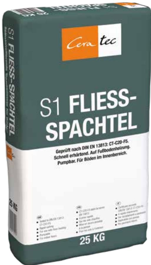
Enduit d'égalisation auto-nivelant à durcissement rapide pour égaliser les sols irréguliers à l'intérieur jusqu'à une épaisseur de couche de 30 mm. L'Enduit fluide Ceratec S1 est un enduit de lissage pour sols à base de ciment, auto-nivelant et à durcissement rapide, pour les zones intérieures sèches, destiné à égaliser les irrégularités d'une épaisseur de couche de 2 à 30 mm.
