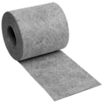
Composant flexible, revêtu de non-tissé sur les deux faces, de la bande d'étanchéité et de découplage Ceratec DF1 DEB dans les étanchéités composites selon DIN 18534. Colmate les fissures, résiste aux alcalis et au vieillissement, en polyéthylène résistant à la déchirure.
