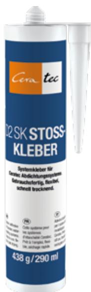
Joint universel monocomposant, très flexible, sans solvants et prêt à l'emploi, à base de polymères. Pour le collage étanche à l'eau des joints bout à bout et des raccords de la bande d'étanchéité et de découplage Ceratec DF1 DEB ainsi que des bandes d'étanchéité, angles d'étanchéité et manchettes d'étanchéité Ceratec correspondantes.
