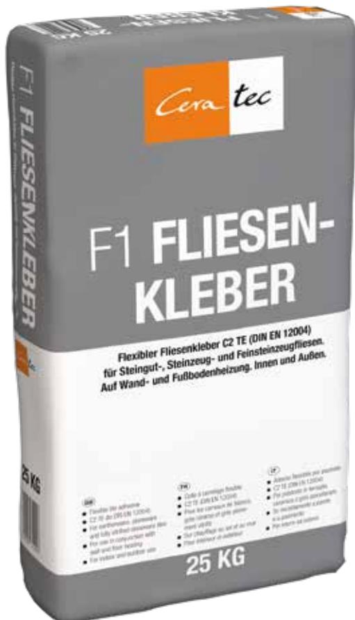
Mortier flexible en couche mince de la classe C2 TE (DIN EN 12004) pour le collage de carrelages de mur et de sol en céramique et d'autres revêtements minéraux pour l'intérieur et l'extérieur. Stabilité et rendement élevés, consistance crémeuse et temps de collage ouvert allongé.
