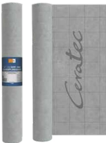
Membrane d'étanchéité en polyéthylène imperméable à l'eau, pontant les fissures, revêtue d'un voile sur les deux faces. Pour une étanchéité et un découplage sûrs et flexibles dans les zones intérieures, les douches et les salles de bains avant les travaux de carrelage selon la norme DIN 18534 partie 5 dans les classes d'influence de l'eau « Faible », W1-I « Modéré » et W2-I « Élevé ».
