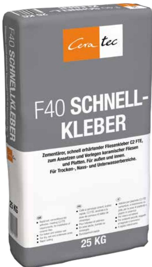
Colle pour carrelage C2 FTE à base de ciment, à durcissement rapide, pour la pose de carrelages et de dalles céramiques ainsi que de grès et de grès cérame fin dans les zones humides et immergées. Convient également pour la pose de plaques de plâtre et d'éléments en mousse dure pour carrelage avec un revêtement de mortier sur les deux faces.
